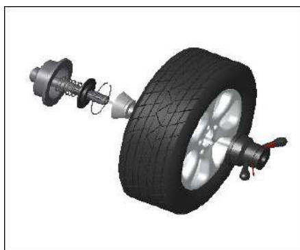
конус «внутри» (на быстрозажимную гайку нужно установить прижимную чашку)
